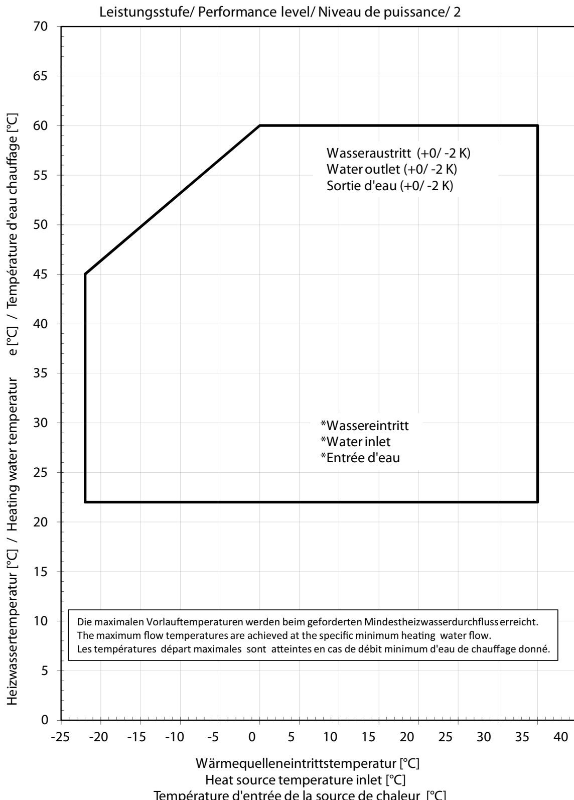
\*Bei Luft/Wasser-Wärmepumpen stellt die minimale Heizwassertemperatur die Mindest-Rücklauftemperatur dar.
