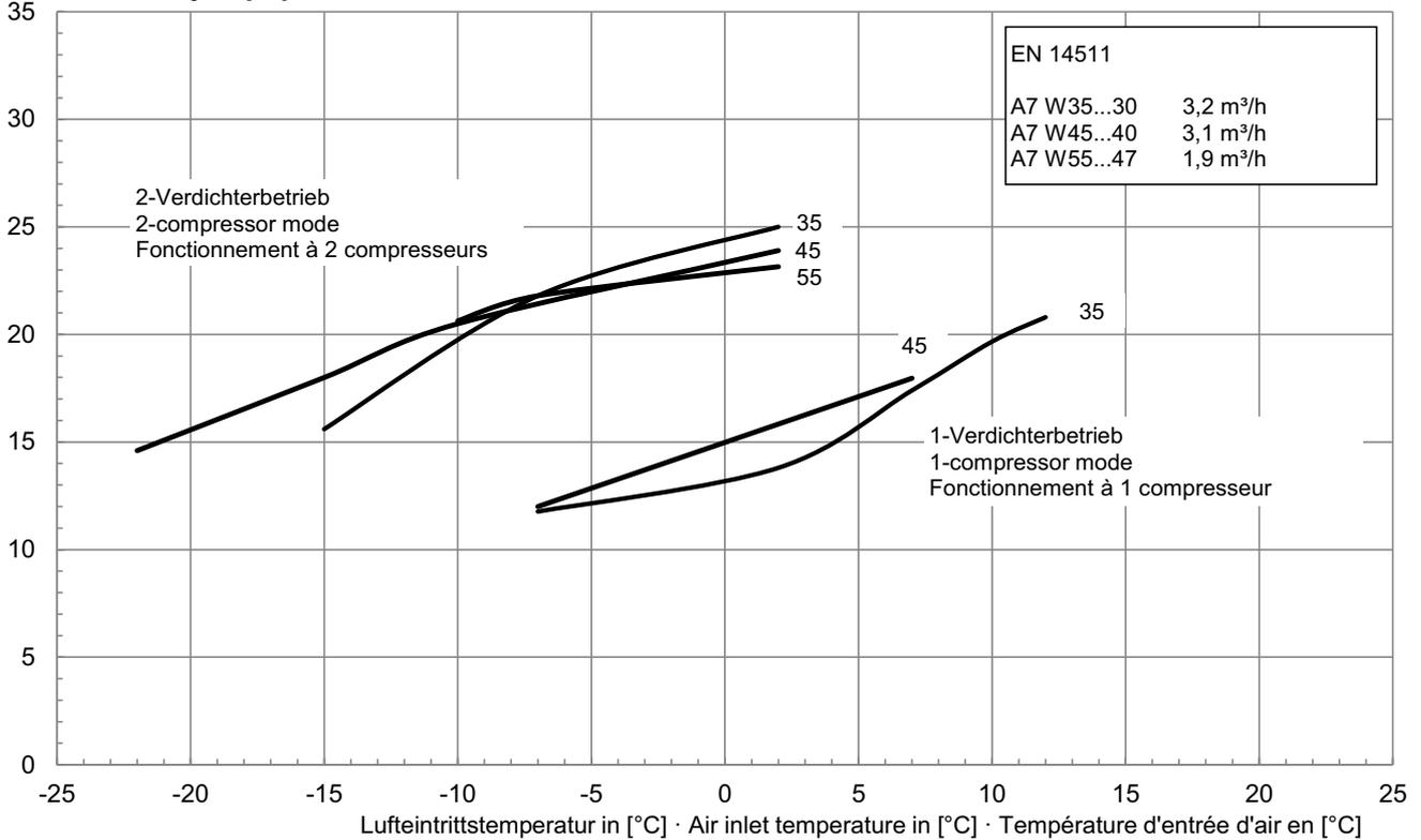
Leistungsaufnahme in [kW] (incl. Pumpenleistungsanteil)
