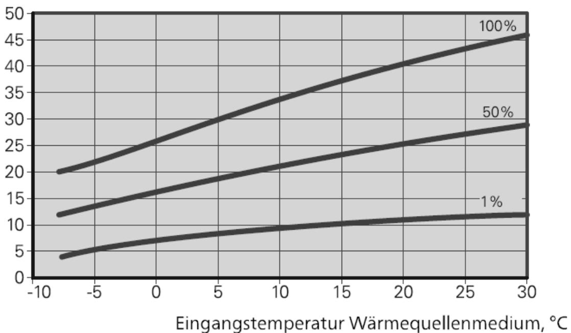
Der Prozentsatz zeigt die Verdichterdrehzahl an.
