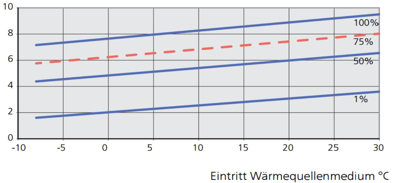
Der Prozentsatz zeigt die Verdichterdrehzahl an.
