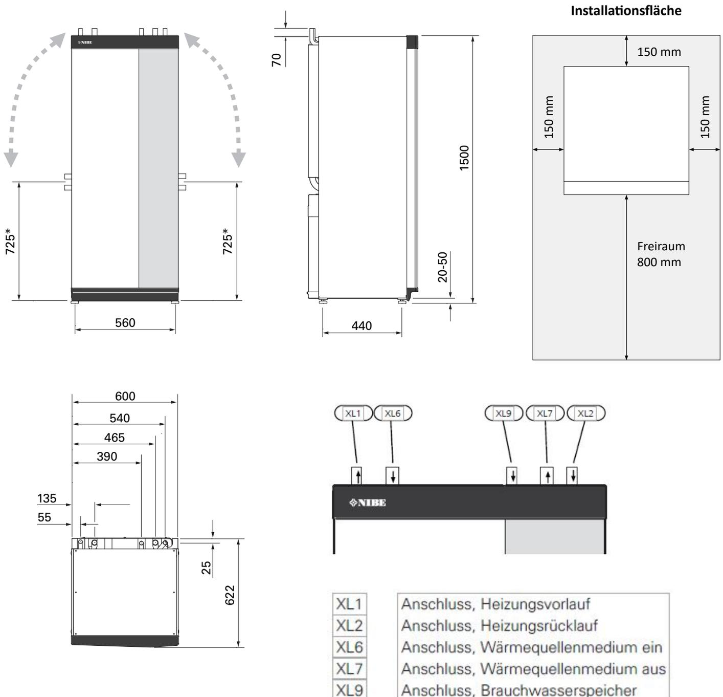
\* Dieses Maß gilt, wenn die Rohre für das Wärmequellenmedium (Seitenanschluss) einen Winkel von 90° aufweisen. Das Maß kann vertikal um ca. ±100 mm abweichen, da die Rohre für das Wärmequellenmedium teilweise als flexible Leitungen vorliegen.
